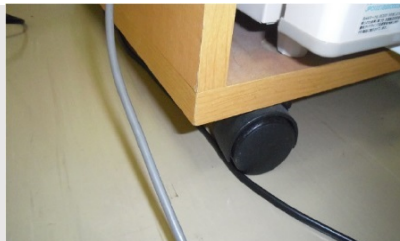
写真②；床頭台のキャスター部分に電源コードが嵌り込んだと思われる状態を再現した
