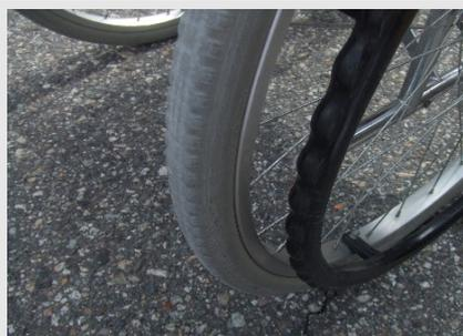
同じ車椅子ではないが20年以上使用された車椅子。タイヤの溝がないとブレーキも効かず、操作性も悪い。パンクでもしない限り、修理（パーツ）交換されない。
