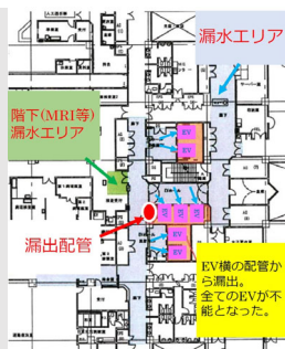
床面漏水状況図
